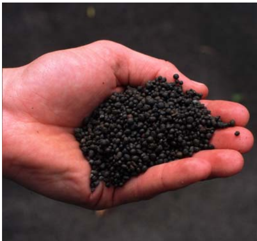
Bild: Fosforbindande material ( www.avloppsguiden.se )
