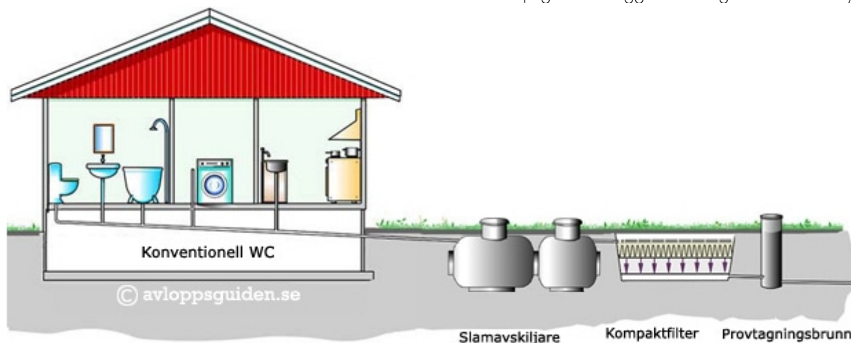
Bild: Principskiss på kompaktfilter ( www.avloppsguiden.se )
