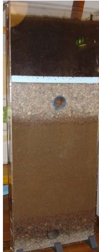
Bild: Markbädd i genomskärning ( www.avloppsguiden.se )
