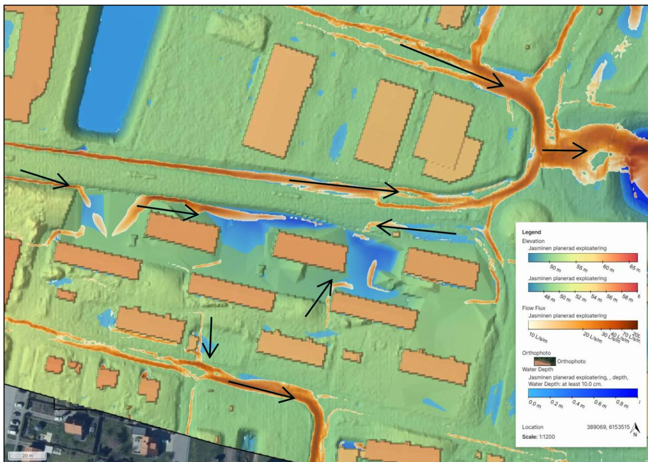
Figur 7-3. Översvämningssituation vid planerad förtätning vid ett klimatanpassat 100-årsregn som analyserats i SCALGO DynamicFlood. Notera att använd höjdsättning är översiktlig. Pilarna visar på flödesriktning.
