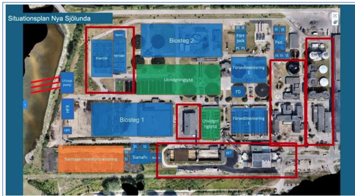
Figur 3 Översiktsplan över Sjölunda ARV. Röd ram visar befintliga anläggningsdelar som helt eller delvis behålls, placering av nya anläggningsdelar markeras med blått och grön markering visar ytor avsatta för framtida expansionsmöjligheter. Orange yta visar avsatt yta för ev. framtida slamförbränningsanläggning. VA SYD Samrådsunderlag 2021-06-24.
